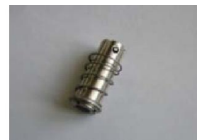
Плунжер с неподвижным конусным и цилиндрическим уплотнением (Старая конструкция плунжера)
