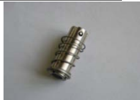
Плунжер с неподвижным конусным и цилиндрическим уплотнением (Старая конструкция плунжера) Фото – 5
