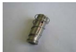
Плунжер с движущимся уплотнением (Новая конструкция плунжера)
