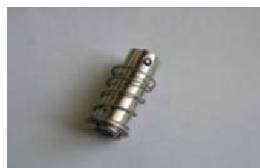
Плунжер с неподвижным конусным и цилиндрическим уплотнением (Старая конструкция плунжера)
