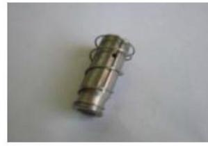
Плунжер с движущимся уплотнением (новая конструкция плунжера)
